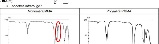
En comparant les spectres du réactif et du produit, on constate la disparition d'un pic vers 1650 cm<sup>-1</sup> pour le polymère formé.
